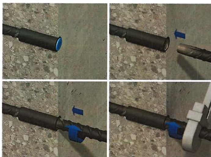
Слика 2: Пример настављања арматурних шипки употребом система „ANCON TTS“
